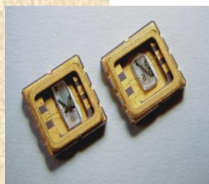
Рис. 1. Модель, характеристики проводимости STW-резонатора на частоту 765 МГц
