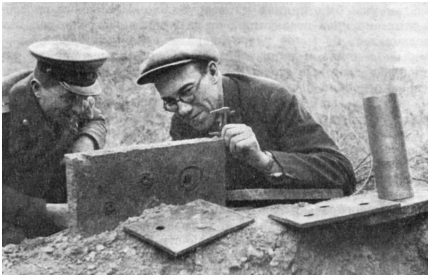
1944 г. М.А. Лаврентьев - профессор Военно-Воздушной Академии имени Жуковского. Исследование пробивания танковой брони кумулятивным снарядом.
