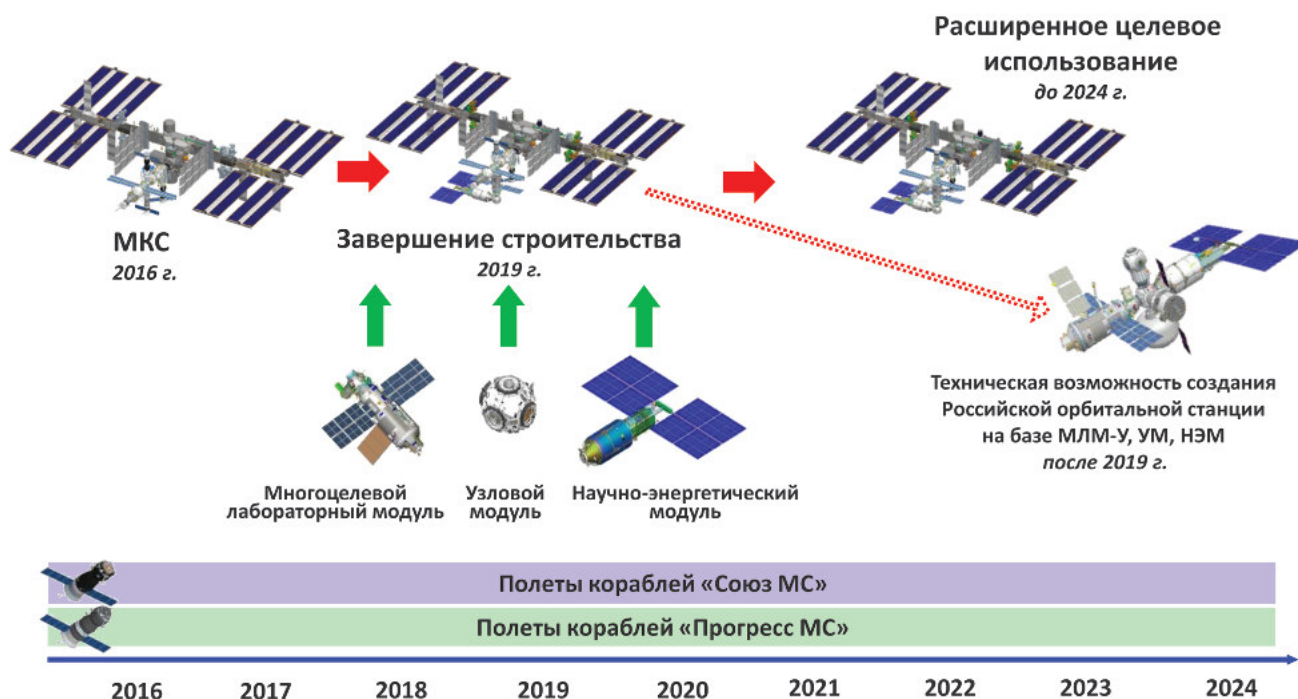
Рис. 2. Строительство Российского сегмента МКС после 2016 г.
