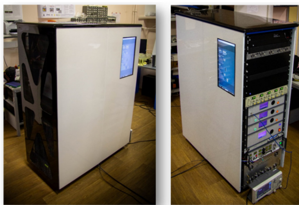
Рис. 4. Генератор ультрастабильных опорных сигналов частоты на холодных ионах иттербия (справа – со снятой стенкой со стороны размещения электронных компонентов)
