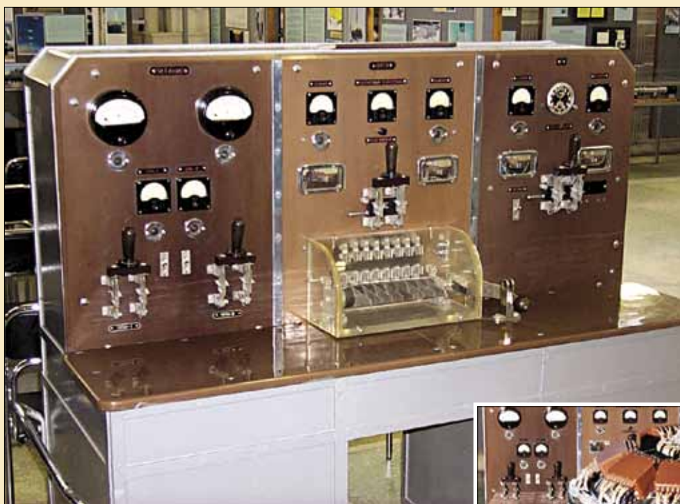
Резервный пульт управления подрыва первого отечественного ядерного заряда. Музей ядерного оружия Всероссийского научно-исследовательского института экспериментальной физики (г. Саров).
