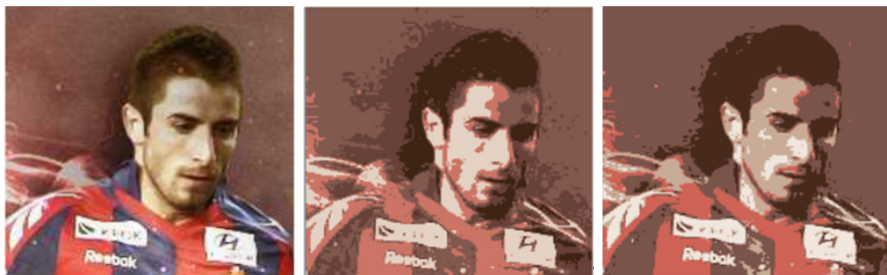
Рис. 1. a) пример сегментируемого изображения; b) результат работы модифицированного алгоритма при k = 25 ; c) результат работы стандартного алгоритма при k = 25
