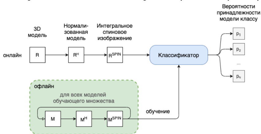
Рис. 1. Схема работы системы классификации трёхмерных моделей
