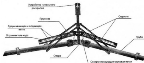
Рис. 2. Фрагмент силового обода и силового узла
