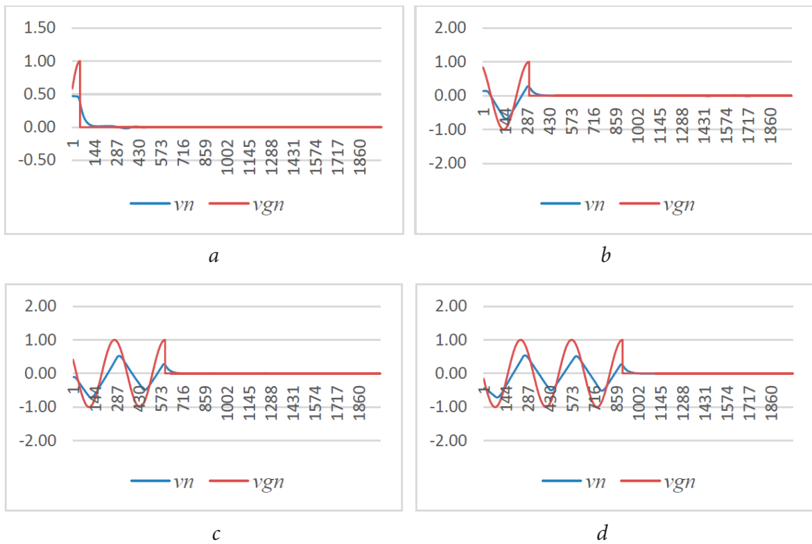
Рис. 5. Безразмерные скорости частиц грунта v_{gn} = v_g / v_{gm} и трубопровода v_n = v / v_{gm} в моменты времени: t = 0.05 с (a), t = 0.3 с (b), t = 0.6 с (c), t = 0.9 с (d)
