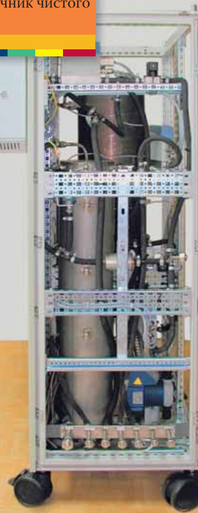
Мини-завод для производства водородсодержащего газа на основе реакции паровой конверсии метана. Рабочая температура – 750–950 °С; производительность по синтез-газу – до 5 м 3 /ч; удельная производительность по синтез-газу – до 0,13 м 3 ч.л
