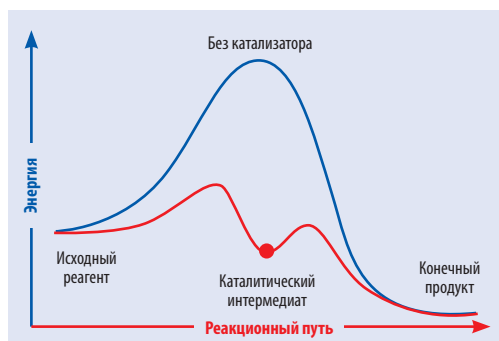
Рис. 1. Как работает химический катализатор? Катализатор – это вещество, которое управляет направлением и скоростью химических превращений за счет промежуточных взаимодействий с участниками реакции и которое регенерирует свой состав после завершения цикла этих превращений и не входит в состав продуктов реакции.
