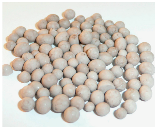
Рис. 3. Катализатор ароматизации попутных газов (промышленное производство мощностью 150 т/год, Новосибирск).
