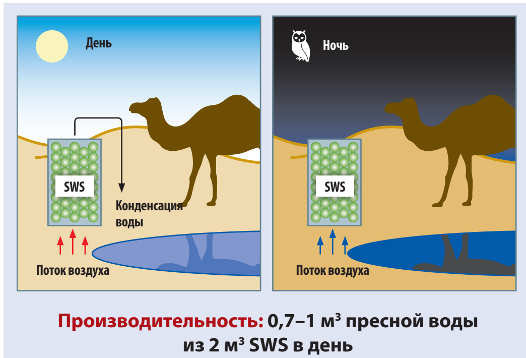
Рис. 26. Способы получения пресной воды с использованием селективных сорбентов воды (SWS).
