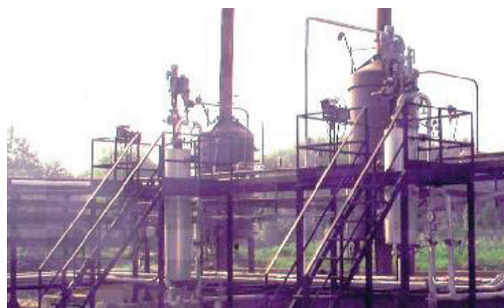
Рис. 6. Установка мощностью 4000 тонн в год по сырью, принадлежащая ОАО «НИПИгазпереработка»* (г. Краснодар), на которой проводились опытно-промышленные испытания технологии БИМТ.
