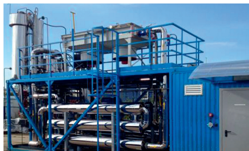
Рис. 8. Опытно-промышленные испытания установки мягкого парового риформинга на Крапивином месторождении (Томская обл.) ПАО «Газпром нефть» лето-декабрь 2015 г.
