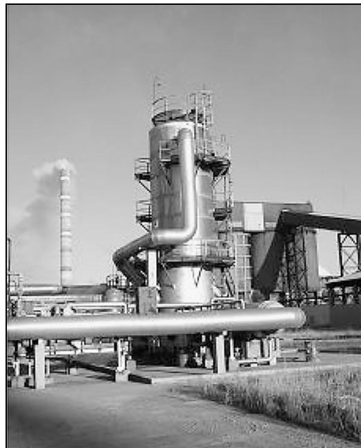
Рис. 3. Промышленная установка очистки газов от сероводорода на ОАО «Газпромнефть–Омский НПЗ» производительностью 10 тыс. м 3 /ч
