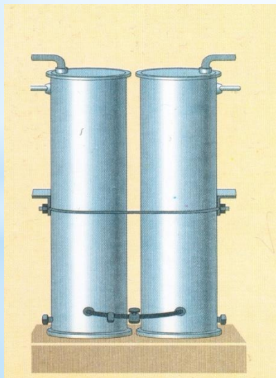
Вертикальный бак аварийного запаса воды
