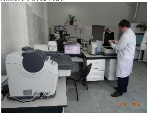
Рисунок 3.2.1 – Подготовка к исследованию серии углеродных образцов на комбинированной установке Nicolet DXR Smart Raman, включающей дисперсионный КРС-спектрометр с тремя лазерами и конфокальный Раман-микроскоп
