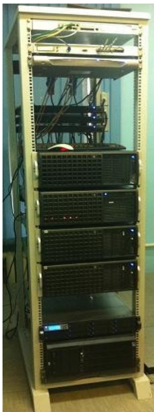
Рисунок 3.5.4 - 4-х модульный суперкомпьютерный кластер Tesla (1440 потоковых процессоров; Пиковая производительность 5052 Gflops).
