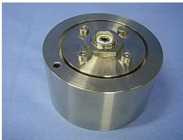
Рисунок 1 - Экспериментальная установка для определения удельного сопротивления
