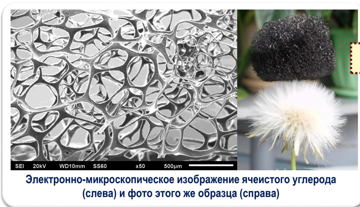
Материал перспективен в качестве теплоизолятора для применения в изделиях и конструкциях, эксплуатируемых в условиях крайнего Севера и арктических регионов.
