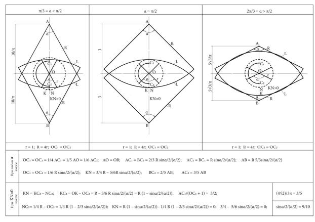
Рис. 2. Обоснование условия касания исходной окружности и развернутой дуги
