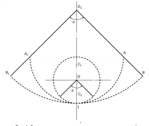
Рис. 1. Схема распускания окружности относительно точки 1
